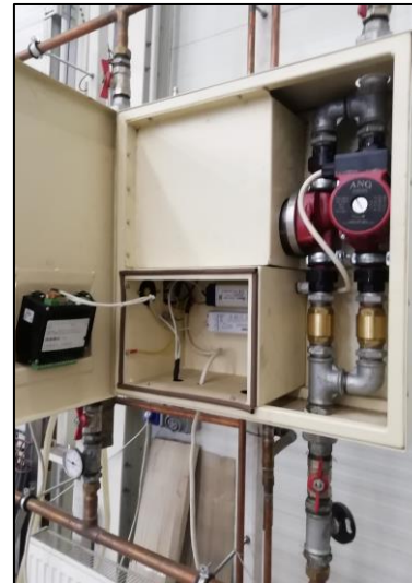
Tesztállvány három különálló kettősüzemű keringető körrel
