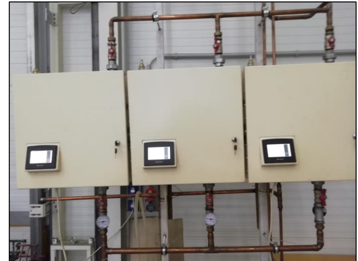
Tesztállvány három különálló kettősüzemű keringető körrel
